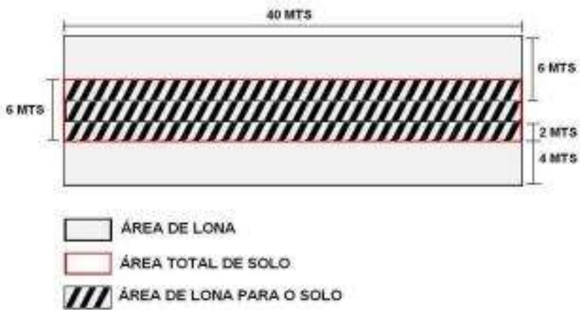
Figura 2 - Esquema da depopulação por injeção de gás carbônico ( \text{CO}_2 ) - planta baixa
